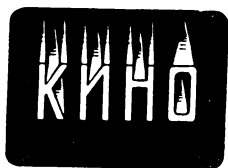
Рис. 14. Изображение, проецируемое на экран при «тяге» обтюратора
